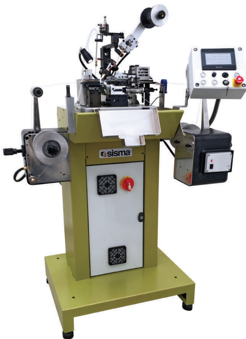
Soldering machine for filling Saldatrice per riempimento catene
