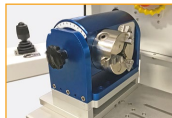
Rotating spindle with drive (4 th axis) Mandrino con azionamento (4 o asse)
