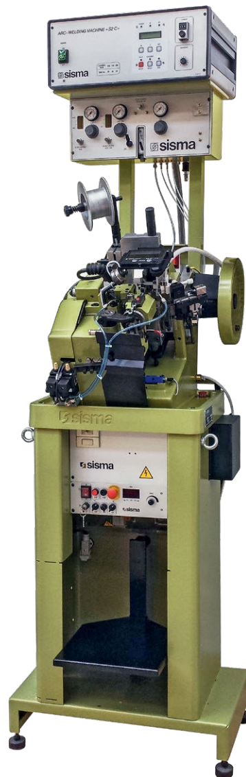
Macchina automatica per catene gourmette e forzature singole, doppie e triple
